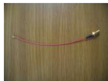
케이스 장착용 연결 케이블 (PN-CABLE-UFL-SMABJ)
