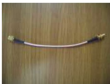
케이스 장착용 연결 케이블 (PN-CABLE-SMAP-SMABJ)
